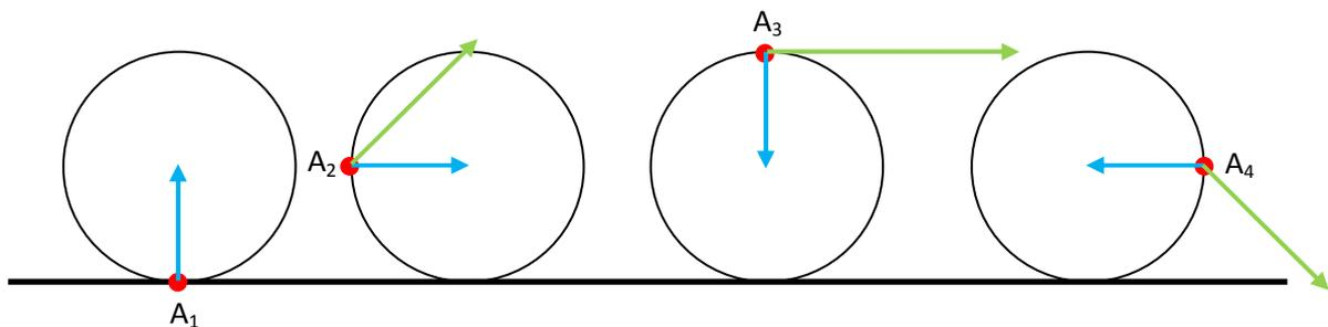
**IMPORTANTE:** Se puede observar que, cuando el borde de la llanta (P) se encuentra sobre la superficie (punto  $A_1$ ), P no tiene velocidad pero sí tiene aceleración. Esta es una particularidad que es consecuencia de la relación entre la velocidad del centro de la llanta y la velocidad angular. Tengan en cuenta este resultado para cuando estudiemos mecánica del cuerpo rígido, en el caso que un cuerpo rueda sin deslizar
